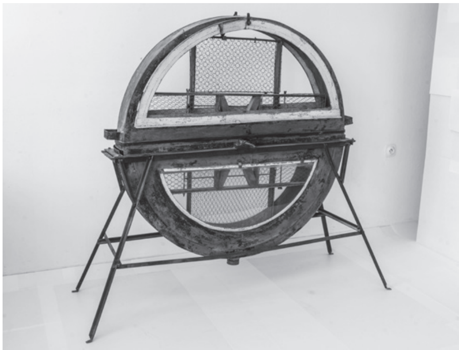
Obrázok č. 2: Paralelnoradiálny medomet na štyri rámiky z prvej polovice 20. storočia
