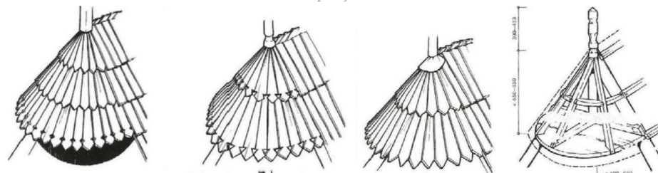
Obrázok 19 Kukla – nosná konštrukcia a možnosti úpravy
